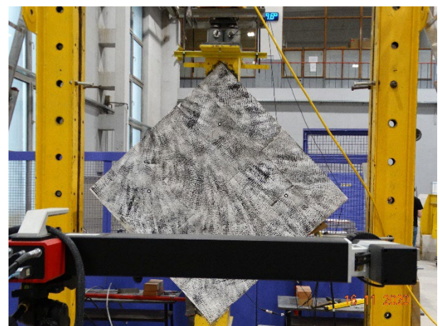
Rys. 2. Model przygotowany do badań na stanowisku do ukośnego ściskania
